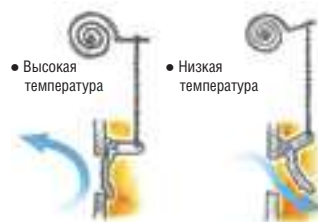
Идеальное горение поддерживается устройством функции автоматического регулирования температуры.
