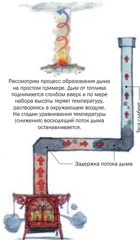
Благодаря теплоизоляции двухслойная труба поддерживает высокую температуру дыма.
